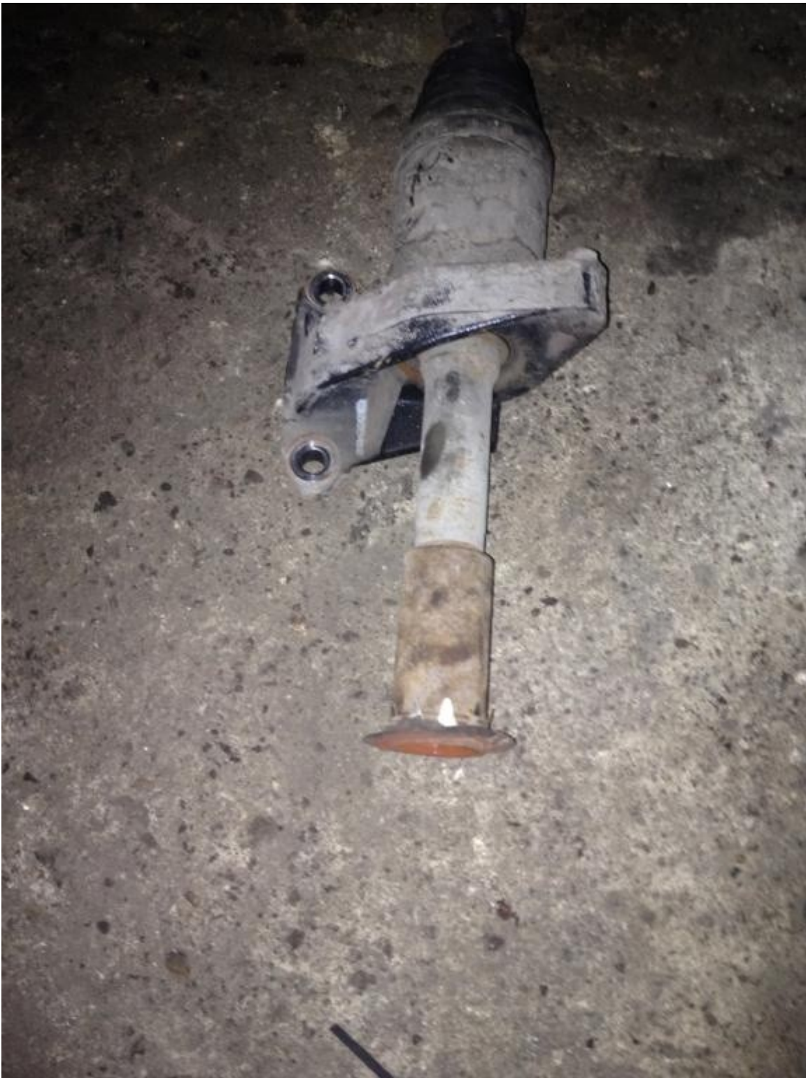
Nowa tuleja i odświeżona półoś papierem ściernym i sprayem czarnym matowym
